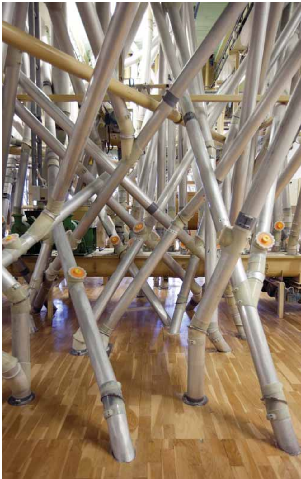
Transportrör mellan siktar och kvarn i kvarnbyggnaden.
